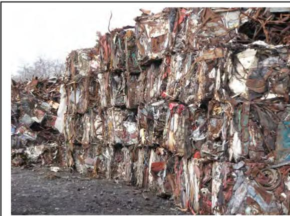
Bild 19 Schrottbälle für den Elektroofen
