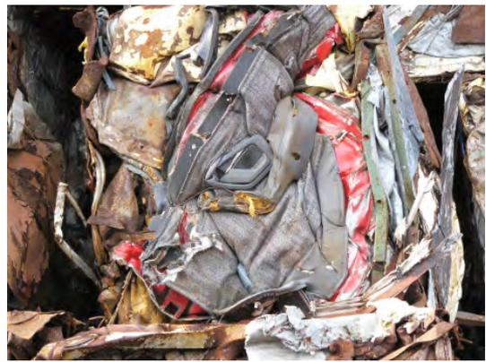
Bild 20 Kunststoffe, Plaste, Lacke ... im Schrott
